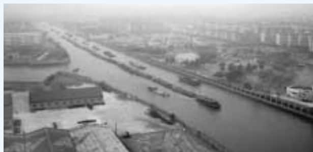
発達している運河網を、ひっきりなしに貨物列「船」が行き交う。10隻連ねれば3,000tもの石炭や建築資材、石材を長江デルタ一帯に運搬可能だ。
